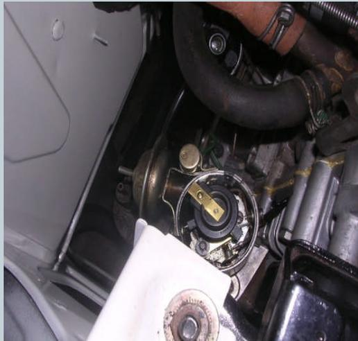
Remplacement du rupteur, condensateur, tête d'allumeur avec le doigt, des bougies et du faisceau antiparasite. Réglage du point d'avance.
