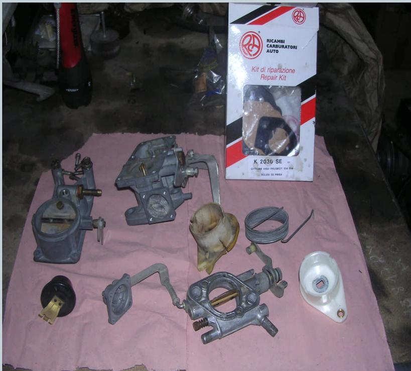
Démontage et nettoyage complet du carburateur, remplacement des joints, du pointeau et de la Cde d'accélérateur. Fait les réglages de base.
