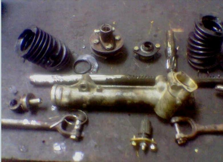
Dépose et déshabillage de la direction complète, nettoyage.
