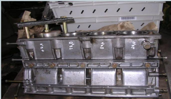
Control de l'ovalisation des chemises (RAS) déglacés et fait les hauteurs de chemises en mettant les bon joints de papier
