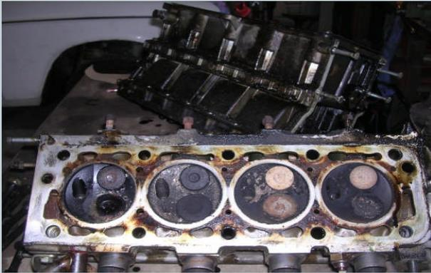
Pas de grand travaux .Déshabillage complet pour l'éprouver et contrôle de la planéité .
