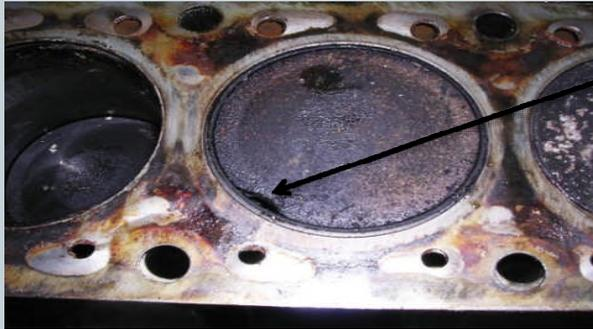
La cause est: piston du 3eme cylindre fendu et des segments cassés sur tous les pistons
