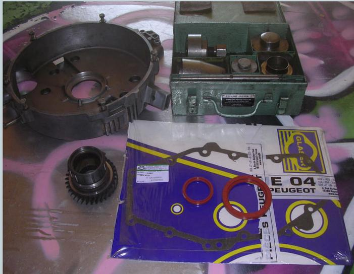
Remplacement des joints spi et du joint de carter.
