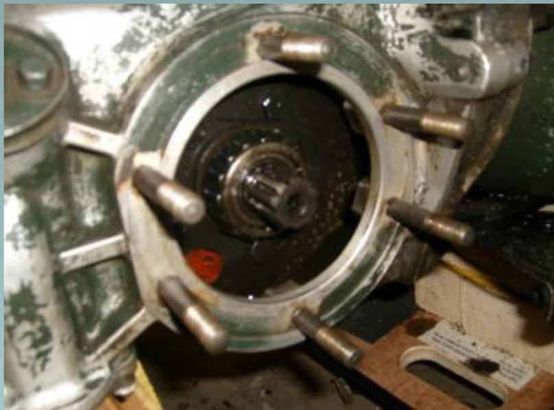
Voilà, la flasque est retirée le plan de joint nettoyé - On aperçoit la cage des galets du roulement conique et derrière la grande couronne du différentiel. C'est là qu'on comprend qu'il est préférable de faire un joint après l'autre pour éviter que le différentiel ne se balade tout seul dans la boîte
