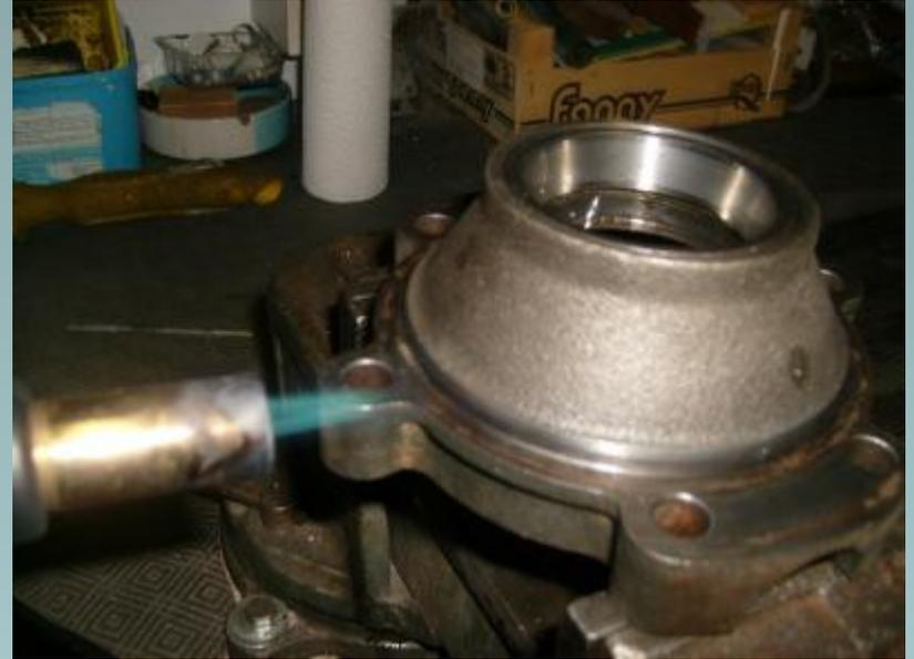
Sortir précautionneusement la cage de roulement (en s'aidant éventuellement d'une chauffe de la flasque )
