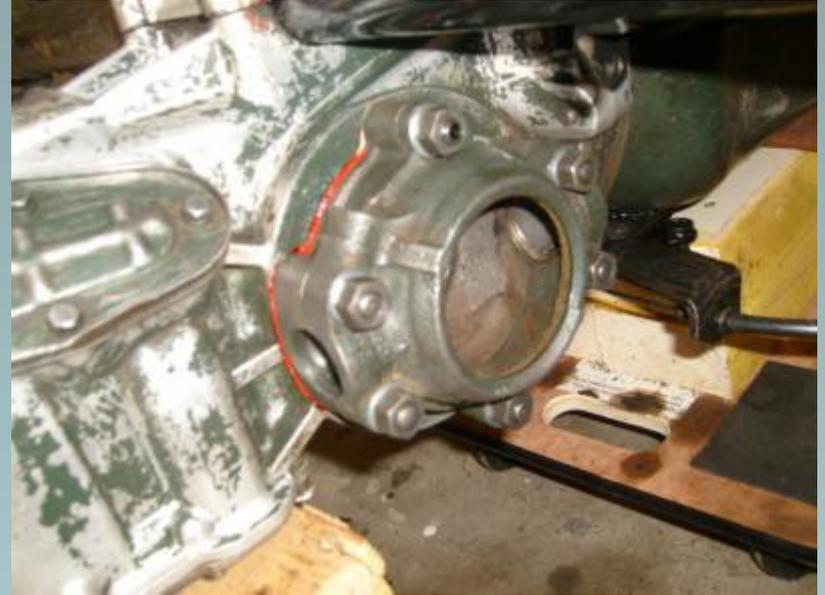
Graisser à la graisse à roulement la cage de roulement et les galets coniques - du joint Loctite rouge sur les portées de joint, le joint papier adéquat entre les deux et y-a plus qu'à remonter avec précaution bien serrer et laisser en place pour que tout ce petit monde prenne sa place (« à réserver » comme on dit en cuisine !)
