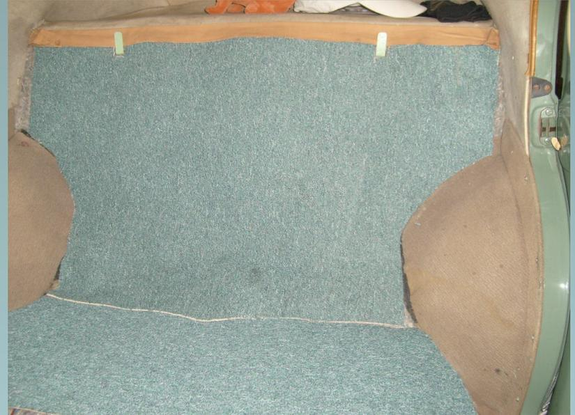
Doublage d'une moquette pour renforcer l'isolation et protéger la « Thibaude » des frottements.
