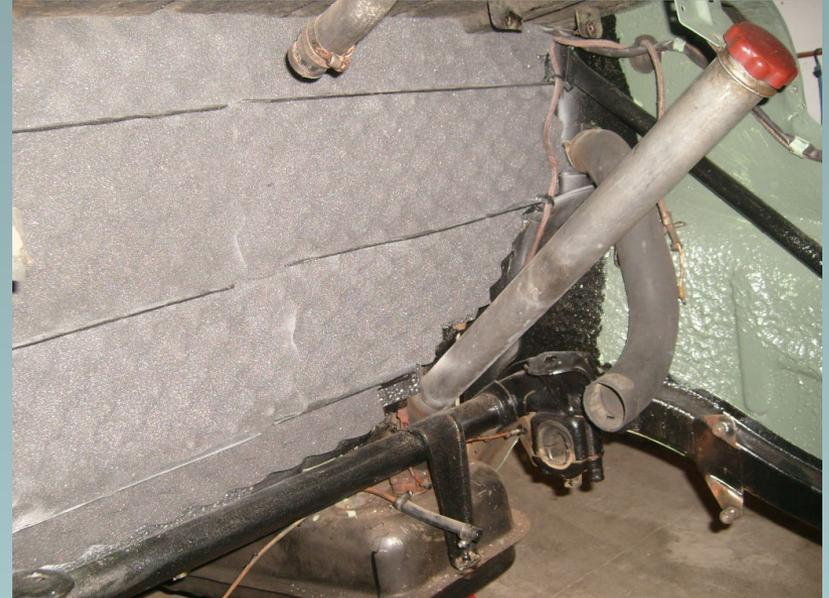
Les plaques de caoutchouc sont enfin recouvertes (collage néoprène) par un revêtement constitué de plaques de mousses alvéolaires anti-bruit (celle qu'on met sous les capots )
