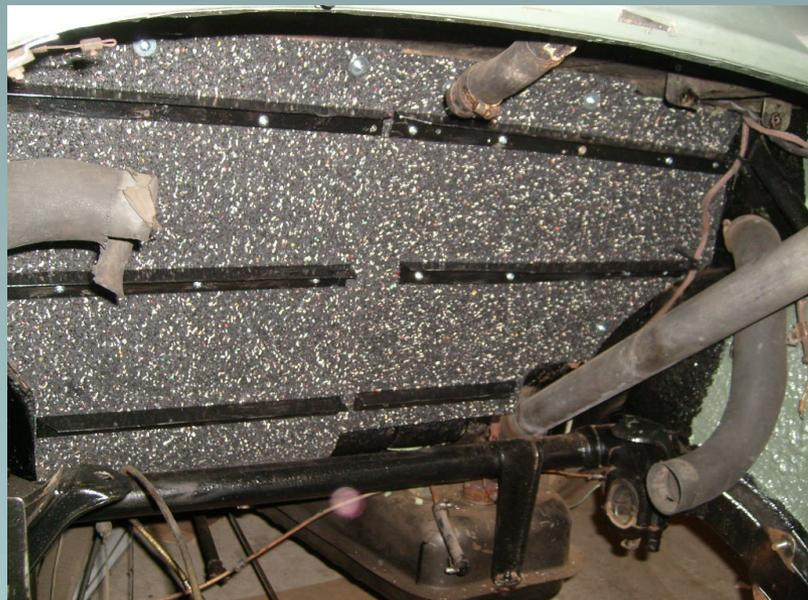
Par-dessus les plaques d'isorel (sur lesquelles j'ai fait un traitement anti-fongique) pose d'un revêtement constitué de plaques anti-bruit en caoutchouc d'une épaisseur de 1cm montées sur un châssis métallique léger.
