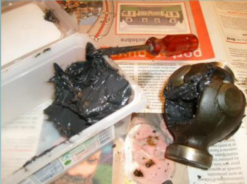
J'ai choisi de ne pas démonter la noix de cardan (j'ai pas osé) Donc je l' ai bien essuyé pour retirer la vieille graisse du mieux que j'ai pu et je l'ai copieusement beurré avec de la graisse noire au molybdène (Loctite) y-a plus qu'a la monter sur son arbre cannelé et remettre en place la vis de maintien
