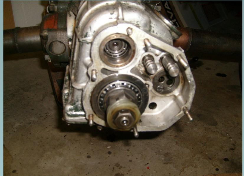
Donc, enlever le joint spi défectueux, bien nettoyer tout ça, bien gratter le plan de joint (en y allant doucement avec une lame de cutter neuve) remplacer le joint spi (13 \* 30 \* 8) ; remonter la fourchette (attention au sens)... et tout remonter avec un joint papier tout neuf et du Loctite rouge 518.
