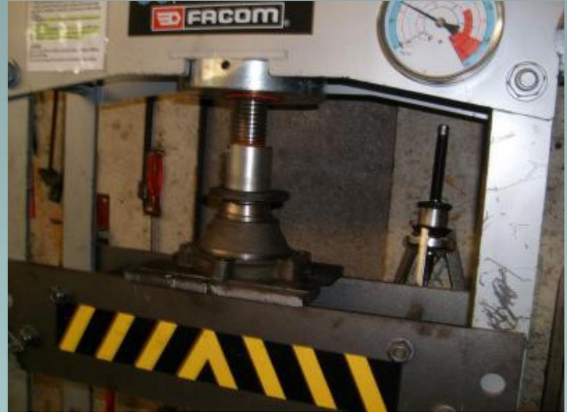
Ouf ! Ça y est c'est sorti : on voit bien la cage de roulement et les 2 cales de réglage
