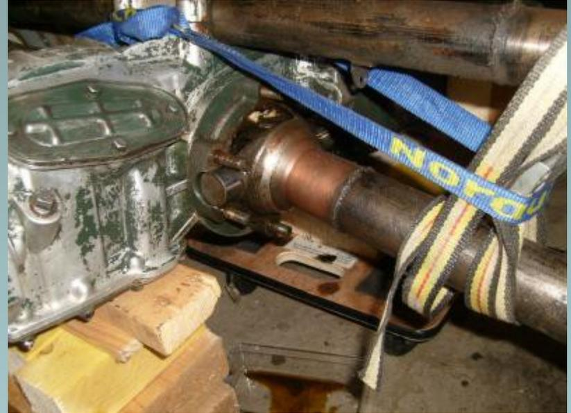
La boîte est calée, on peut procéder au démontage de : la roue - le moyeu-étoile - le ressort de suspension et le tirant (pour le ressort utiliser le cric sous le flasque de frein et une sangle - ça vient facile)
